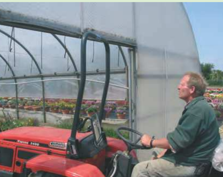
Durchfahrt für Umsturzschtutzbügel zu niedrig
