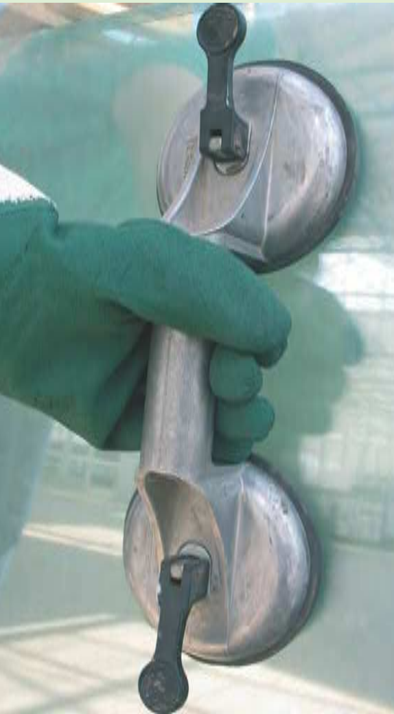
Glasscheibentransport mit Saugnapfgriff und schnittfestem Schutzhandschuh
