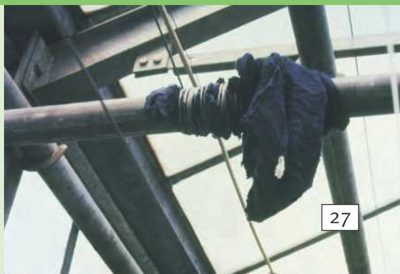
Bild 3 (unten) Erfasstes Kleidungsstück an der ungeschützten Einzugsstelle einer Wickelwelle für einen Energieschirm
