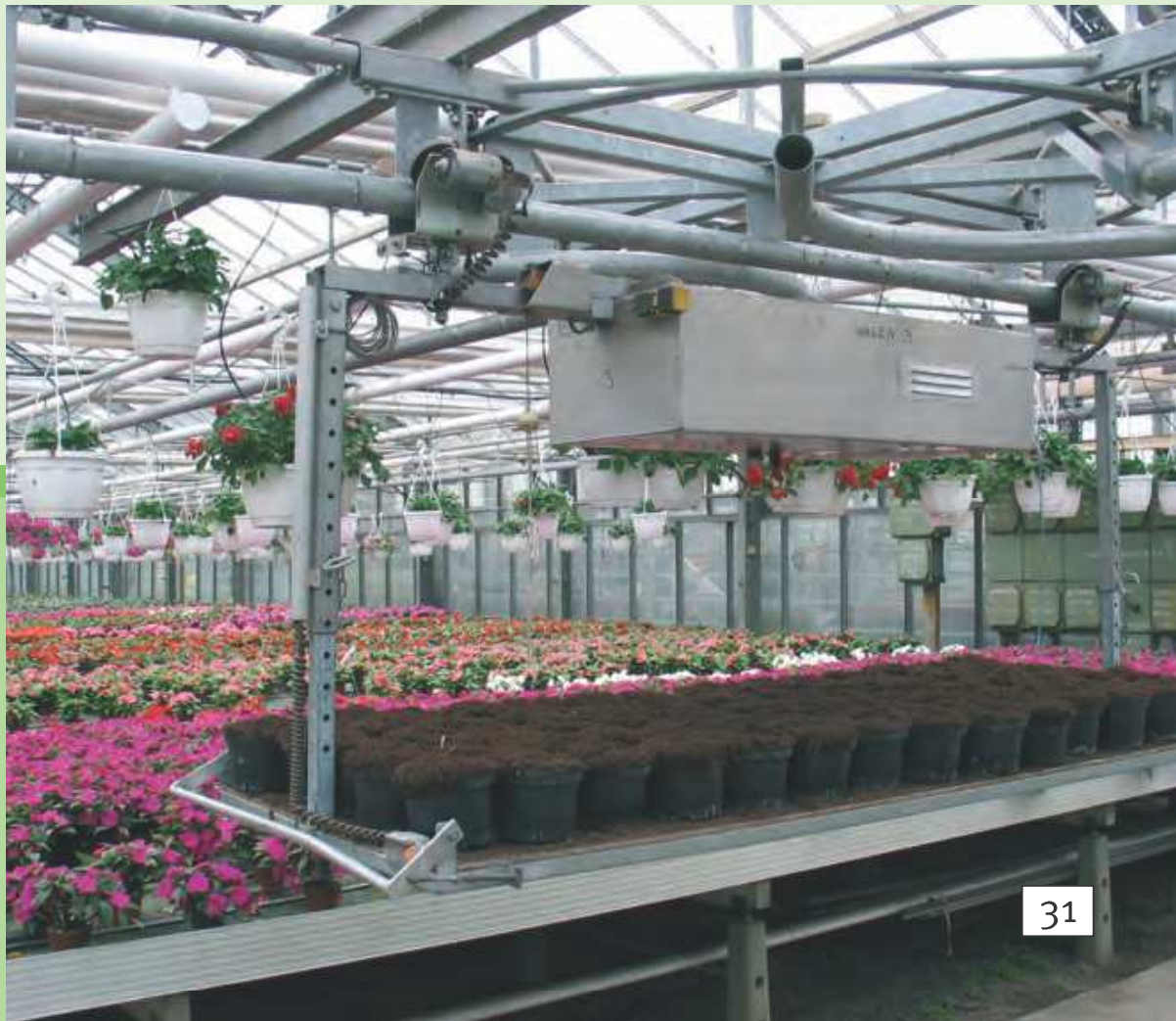
Kraftbetriebenes Transportsystem mit Kontaktleiste
