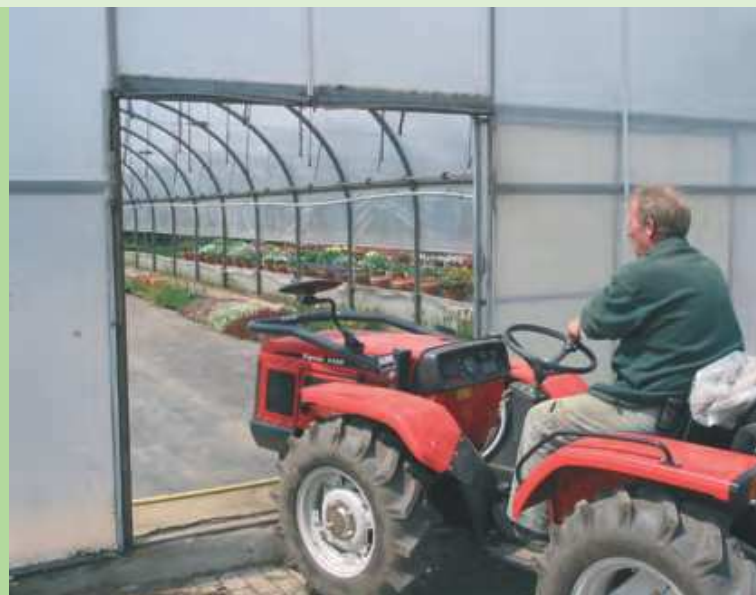
Durchfahrt mit umgeklapptem Bügel
