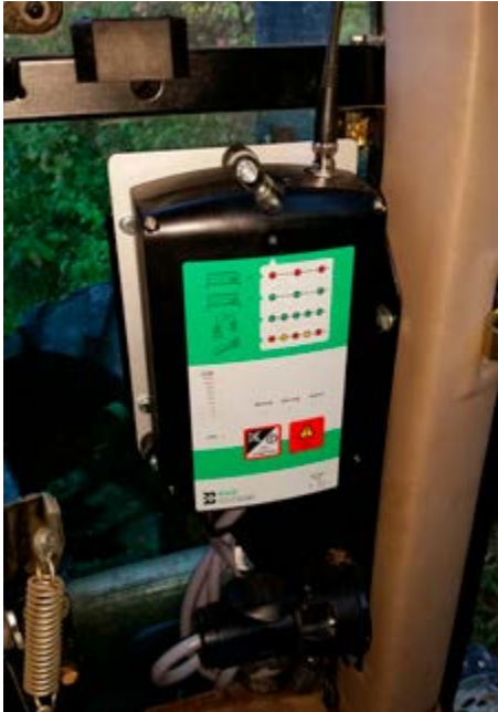
Empfangeinheit einer PNA-Forst in einer Rückemaschine
