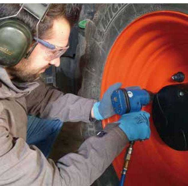
Gehörschutz gehört beim Radwechsel mit Schlag-schrauber zur Persönlichen Schutzausrüstung.
