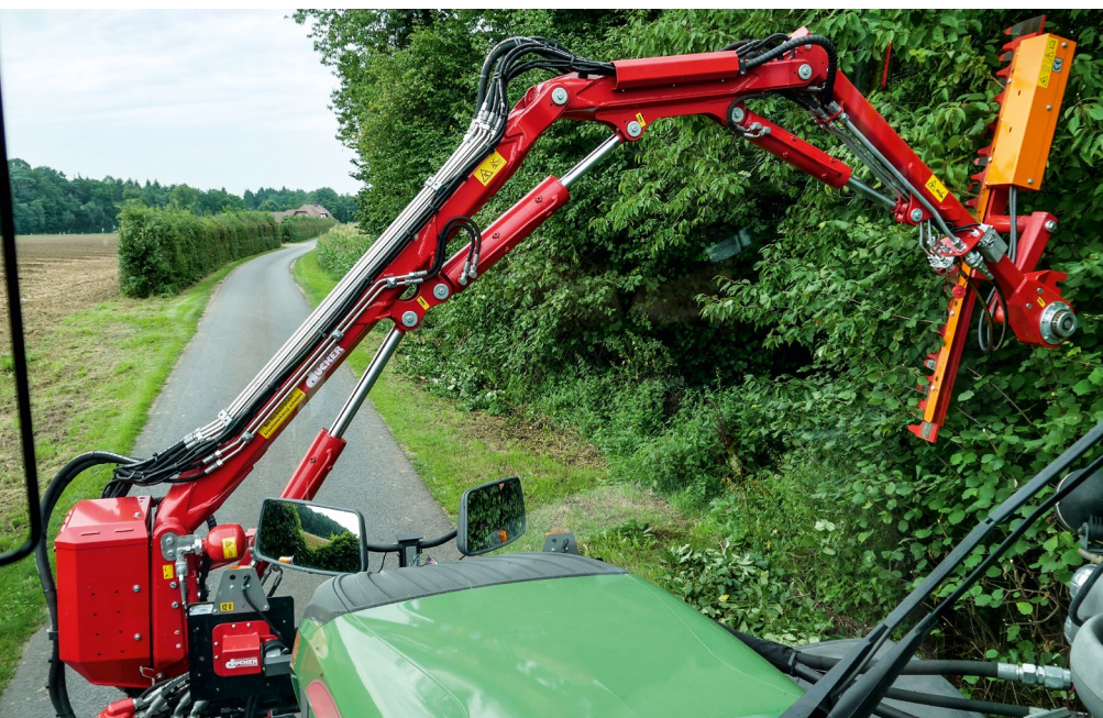
Bei Arbeiten im Straßenbereich mit ausladenden Anbaugeräten ist auf ausreichende Sichtverhältnisse, Verkehrsteilnehmer und Einhaltung von Gefahrenbereichen zu achten.
