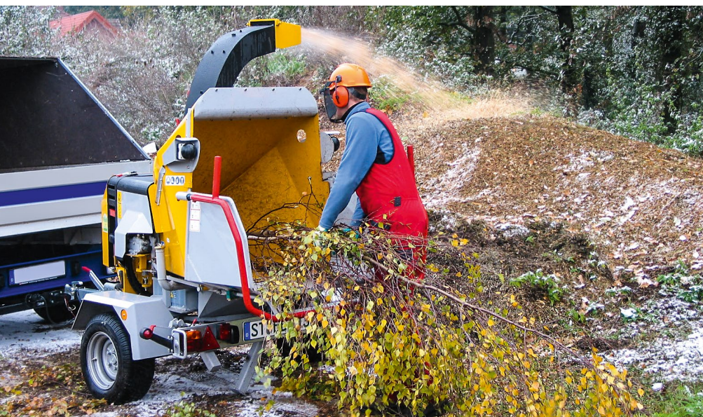
Buschholzhacker im Einsatz
