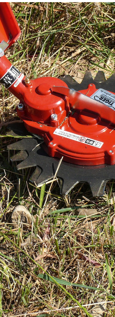
Schneidsystem mit zwei gegenläufig rotierenden Messerblättern
