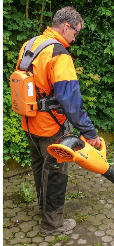
Akku-Laubblasgerät: kein gehör- schädigender Lärm, kein Kontakt mit Benzin und Abgasen
