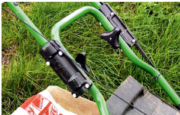
Antivibrationselement am Führungsholm eines Sicheljäähers
