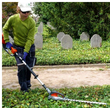
Teleskop-Heckenschere zum Schnitt von Bodendeckern in ergonomischer Haltung
