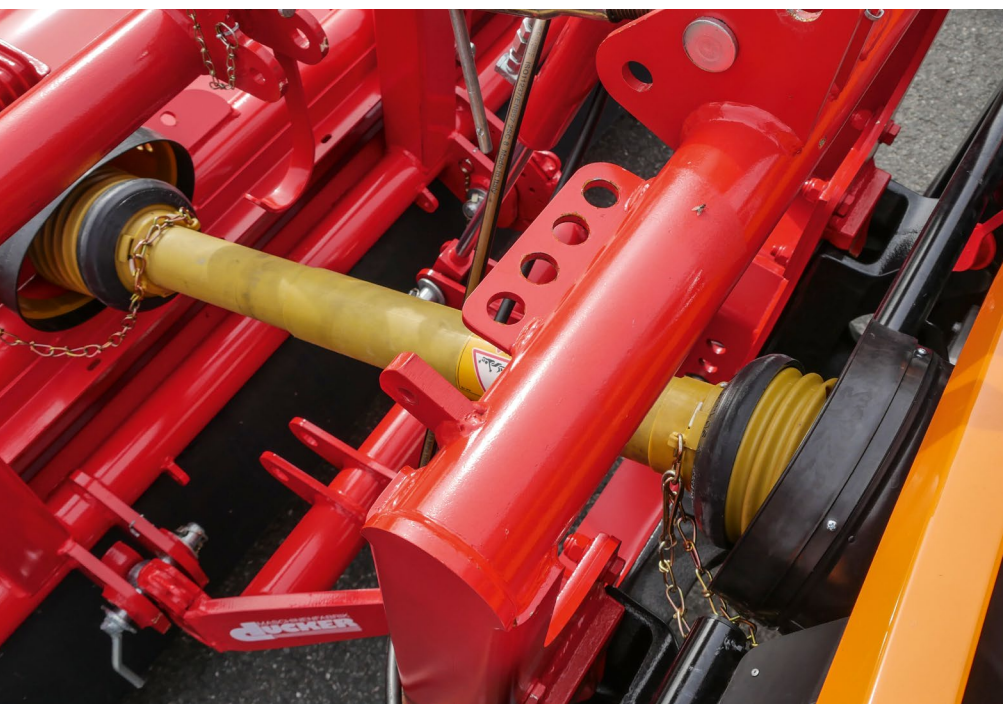
Gelenkwelle mit Schutzeinrichtungen (Sicherungskette, Schutzrohr und Schutztopf)
