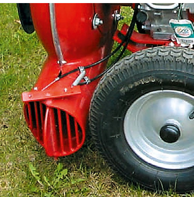
Schutzgitter am Ausblaskanal
