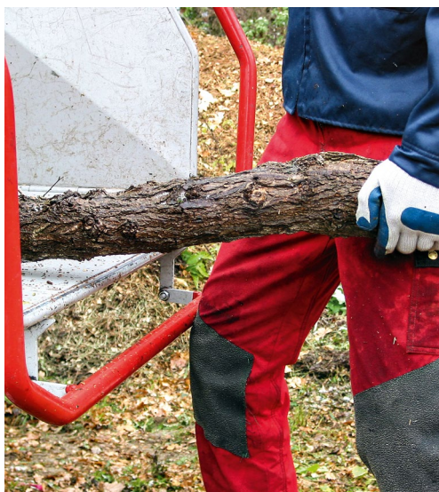
Ein funktionsfähiger Bügel gewährleistet, dass der Einzug im Notfall auch ohne Hände abgeschaltet werden kann.
