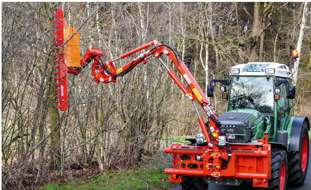
Der Einsatz von Hecken- und Astscheren mit Zweiachsschleppern erleichtert die extensive Grünpflege.
