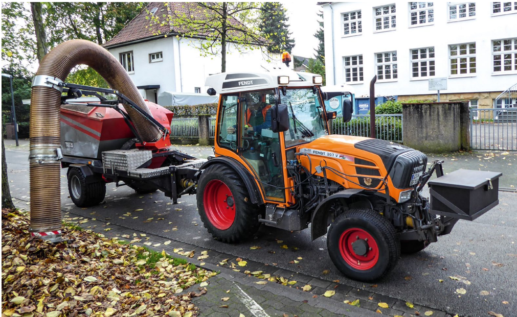
Laubsauggerät mit hydraulisch schwenkbarem Saugrohr
