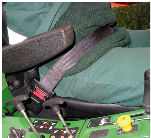
Bei Aufsitzmähern mit Überrollschutzeinrichtung (ROPS) hat der Fahrer den Sicherheitsgurt zu benutzen.
