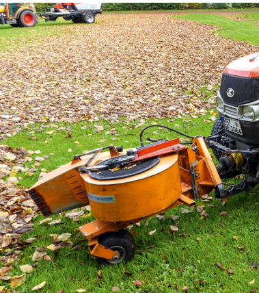
Anbaublasgerät mit hydraulisch schwenkbarem Ausblaskanal
