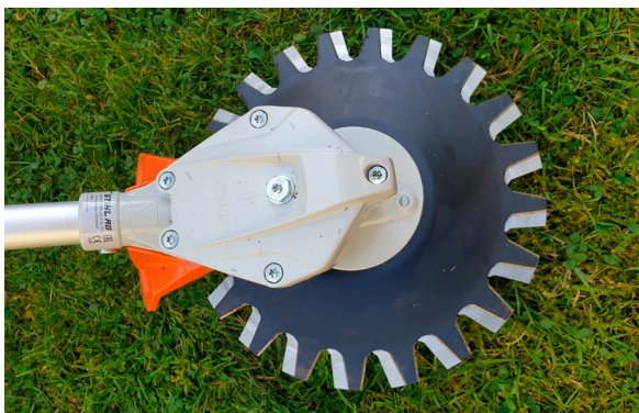
Heckenschereprinzip: Zwei wie bei der Heckenschere gegenläufig arbeitende Messerblätter (die nicht rotieren!) ermöglichen ein schleuderarmes Mähen
