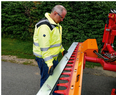
Bei Fahrten auf öffentlichen Straßen werden verkehrsgefährdende Teile wie scharfe Kanten, Schneidwerkzeuge usw. mit Schutzeinrichtungen abgedeckt. Ausleger werden in Transportstellung gebracht und verriegelt.
