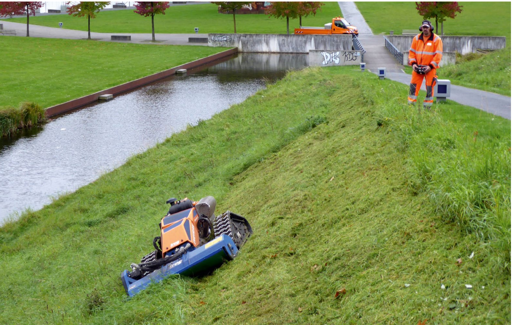
Für Mäharbeiten an steilen Böschungen eignen sich funkferngesteuerte Mähraupen.
