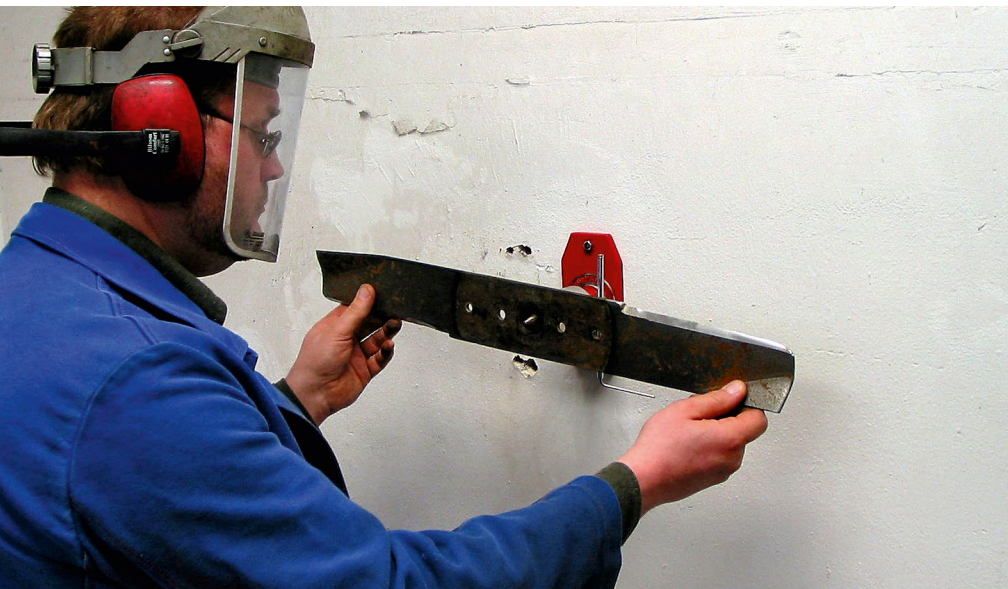
Mit einem Prüfgerät kann eine Messerunwucht festgestellt werden.
