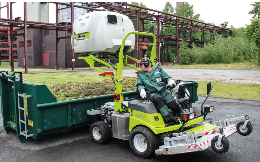
Mähgerät mit angehobenem Grassammelcontainer
