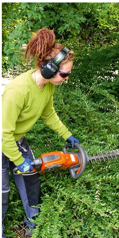
Akku-Heckenschere: weniger Lärm, keine Abgase, weniger Vibrationen
