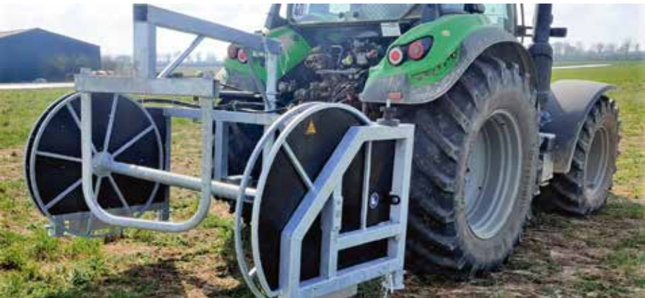
Kann sicher betrieben werden: Folienlegegerät mit hydraulisch zu betätigender Zuführeinrichtung für den Ein-Mann-Betrieb und verkleideten Antriebsselementen.
