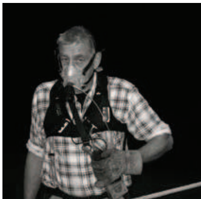
Abbildung 2: Der Proband mit adaptierter Ausrüstung für die Ergo-Spirometrie; die auf der Brust getragenen Elemente haben eine Eigenmasse von nur 1,2 kg; die linke Hand ruht auf der Funkfernsteuerungseinheit für die Seilwinde.
