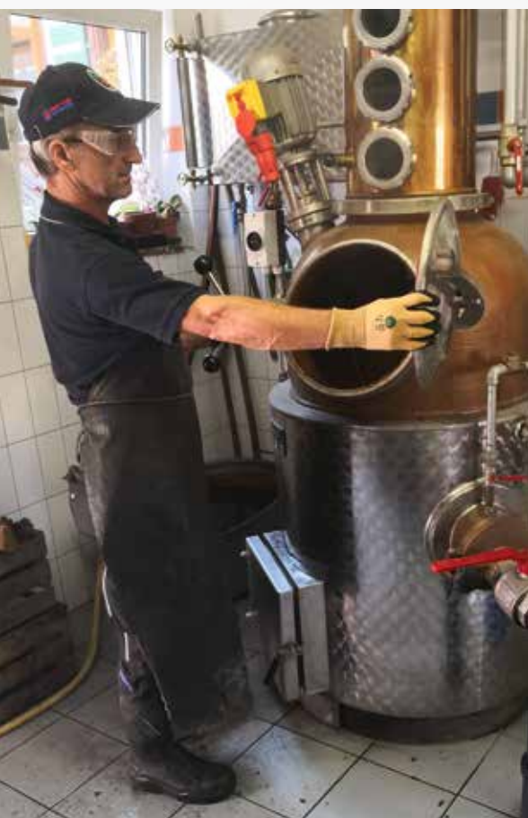
Beim Befüllen der Brennanlage kann es zu Verbrennungen und Verbrühungen kommen. Deshalb ist besondere Vorsicht beim Öffnen der Fülltür geboten.
