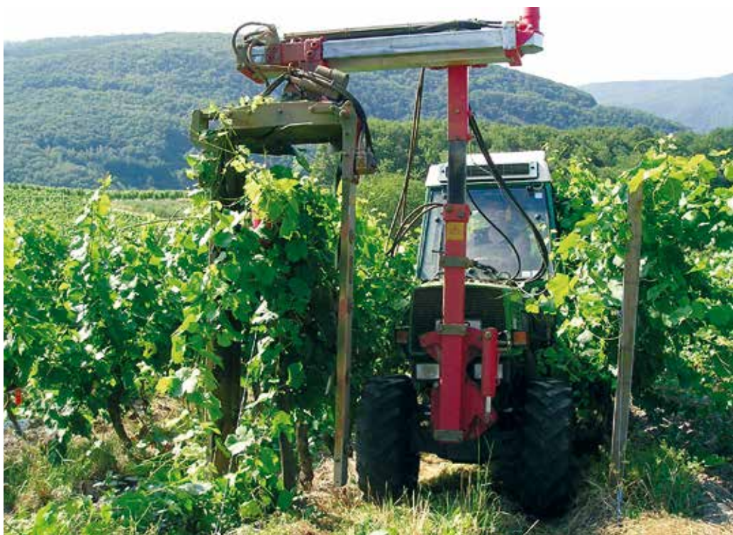
Bedingt durch den hoch liegenden Schwerpunkt besteht bei Schmalspurschleppern eine erhöhte Gefahr des Umkippens.
