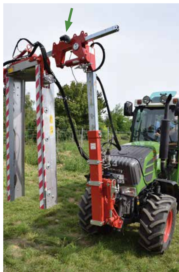
Kamera-Monitor-System zur Sichtverbesserung beim Laubschneideinsatz (siehe Pfeil)
