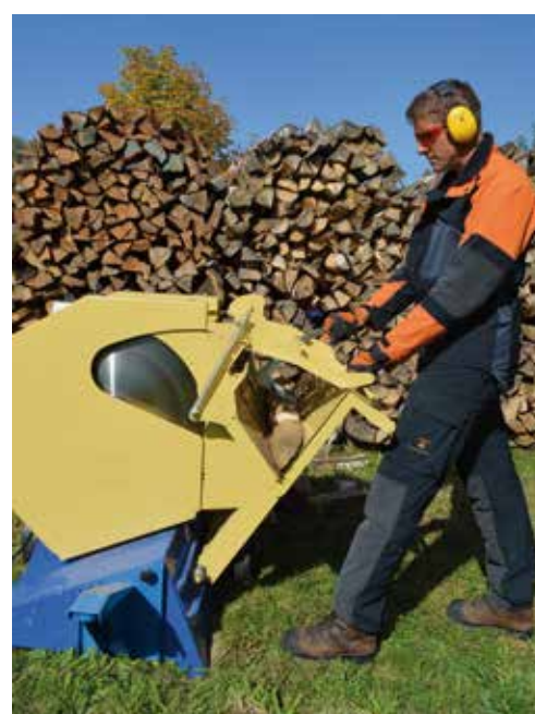
Neue Brennholz-Wippkreissäge mit oberer Schutzabdeckung. Seit Sommer 2018 gilt für Brennholzkreissägen die neue Norm EN 1870-6:2018.
