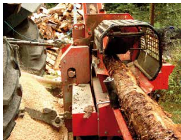
Sicher und schnell: Brennholzaufarbeitung mit dem Säge-Spalt-Automaten
