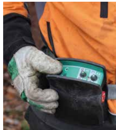
Bleibt die Funkfernbedienung eine gewisse Zeit unbewegt, löst sie zuerst einen Voralarm aus.
