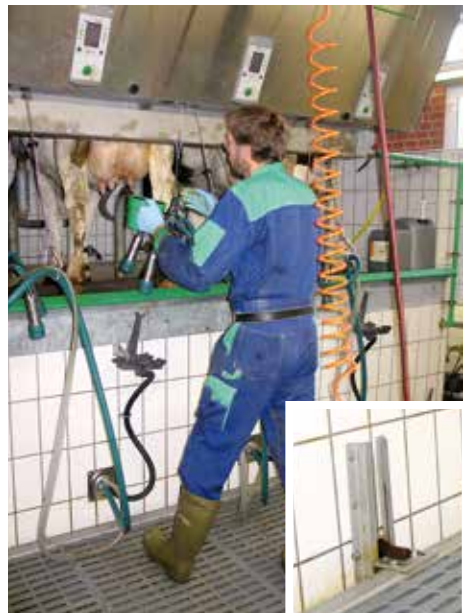
Höhenverstellbarer Boden im Melkstand.
