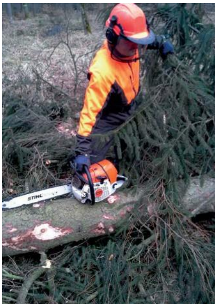
Înlăturarea crengilor cu mâna de accelerare pe mâner este ergonomică și sigură
