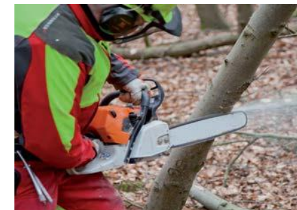
Cu o stabilitate bună și cu motoferăstrăul aproape de corp, rezemat în zona șoldului, stând lateral se efectuează alternativ tăietura oblică și cea de bază
