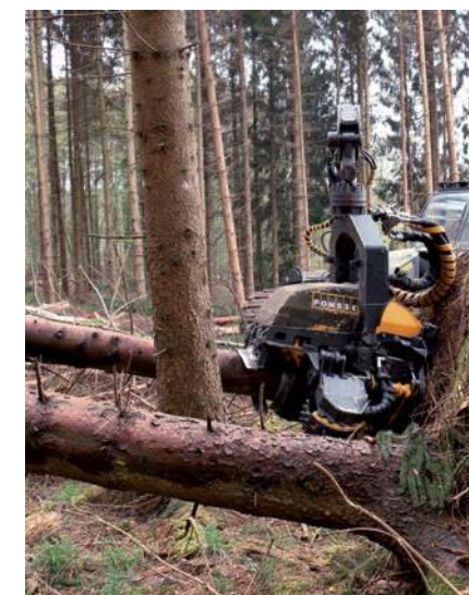
Înlăturarea sigură a tensiunilor și doborârea în cadrul prelucrării complet mecanizate a arborilor distruși de furtună
