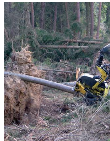
Înlăturarea sigură a tensiunilor și doborârea în cadrul prelucrării complet mecanizate a arborilor distruși de furtună
