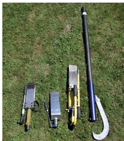
Țapină cu gheară ușoară și "pene tehnice de doborâre" pentru îmbunătățirea ergonomiei în cadrul lucrărilor forestiere
