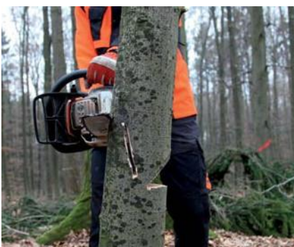
Tăierea benzii de siguranță în cazul tăieturii de crestare diagonale
