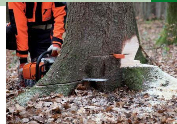
Tehnica regulamentară la doborârea cu cablu: Tăietură sub banda de siguranță
