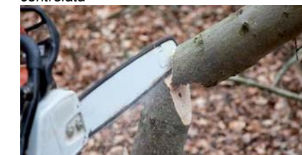
Secționarea părții de tracțiune după diminuarea tensiunii
