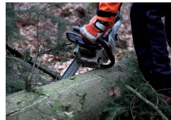
Sprijinirea motoferăstrăului pe trunchi la metoda pârghie
