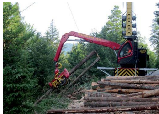
Harvester pentru zone muntoase. Aparat de cabluri integrat pe un camion. Aceasta este o tehnică pretențioasă, care necesită o protecție a muncii la nivel înalt.
