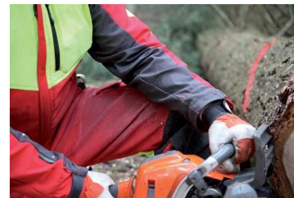
Sprijinirea are loc întotdeauna când este posibil (aici antebraț – coapsă la tăiere)
