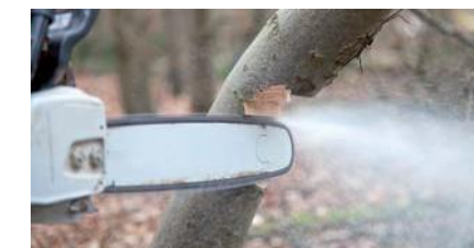
Îndepărtarea lemnului cu tensiuni, diminuarea tensiunii este dată prin îndoirea controlată
