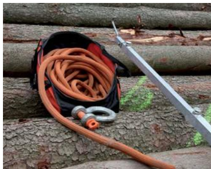
Mijloace de lucru pentru o înălțime de fixare de maxim 6 metri: tijă telescopică cu gheară de fixare, cablu de tracțiune a arborelui (aici un cablu din material plastic cu cămășuială) cu sac de transportare și cercel
