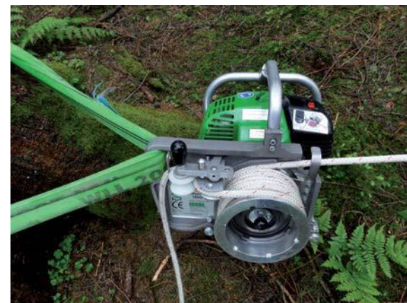
În domeniul forței de tracțiune de până la 1,8 tone, un cabestan poate face lucrul manual cu motor mai ușor și mai sigur
