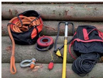
Mijloace de lucru pentru înălțimi de fixare peste 6 metri (până la aprox. 15 metri): sac de aruncare, cablu de aruncare cu un dispozitiv de rulare/derulare, frânghie de tragere, catapultă pentru sacul de aruncat (Big Shot), cablu de tracțiune a arborelui, în acest caz un cablu din material sintetic, cercel, saci de transport
