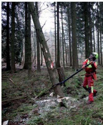
Dislocarea cu țapina cu gheară – lucrați întotdeauna cu tracțiune!!
