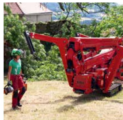
Lautenschlagers entschieden sich bewusst für eine geländegängige Hubarbeitsbühne.
