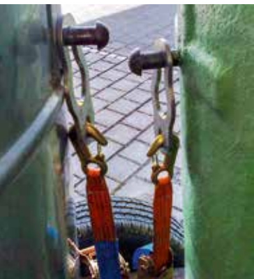
Spezialhalterungen verbinden die Zurrgurte fest mit den Zubern
