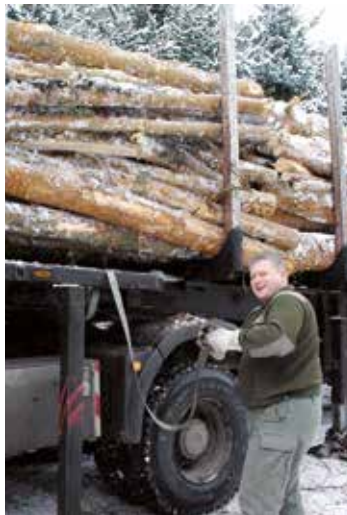
Automatisches Nachspannen der Zurrgurte durch Luftdruck spart das Nachzurren
