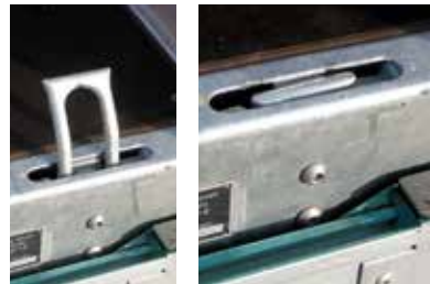
Aus dem Rahmenteil der Ladefläche ausziehbarer Zurropunkt
