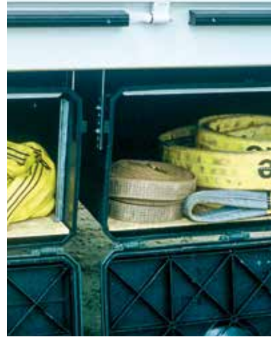
Transportbehälter für Zurrmittel wirken einem zusätzlichen Verschleiß entgegen
