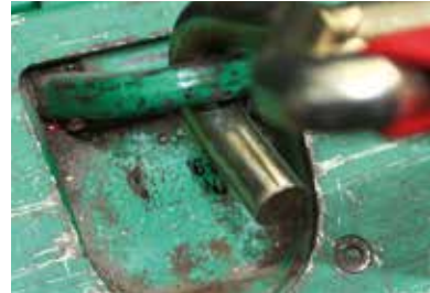
Zurropunkt an einem Fahrzeug mit eingepprägter Zurrrfestigkeit in daN
