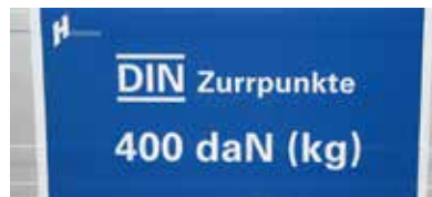
Kennzeichnung eines Zurropunktes für ein Fahrzeug mit einer zulässigen Gesamtmasse von 3,5 t
