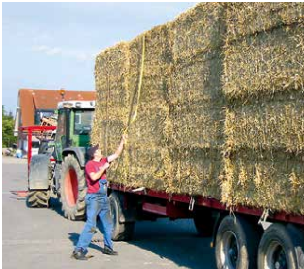
Kraftschlüssige Ladungssicherung durch Niederzurren
