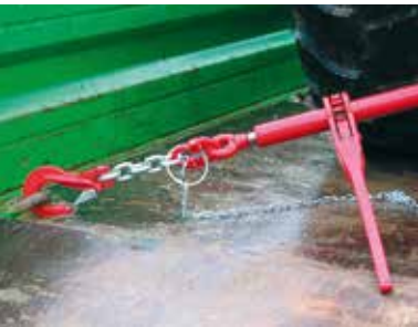
Ladungssicherung mittels Zurrkette (hier mit Ratschenspanner)
