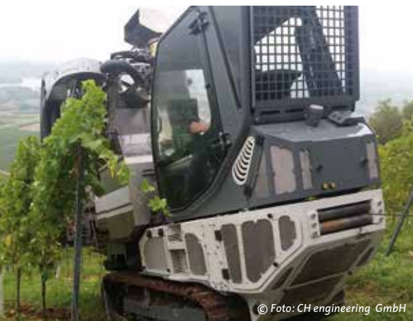
Steillagen-Vollernter mit Kettenlaufwerk sichern sich über Seilwinden gegen Umkippen.
