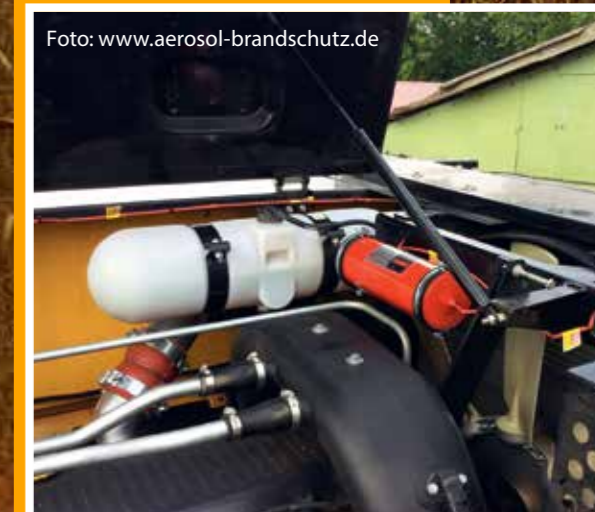
Foto: www.aerosol-brandschutz.de Aerosol-Löschgeneratoren werden direkt in den zu schützenden Bereichen installiert. Sobald ein Brand erkannt wird, löst der Löscher aus.
