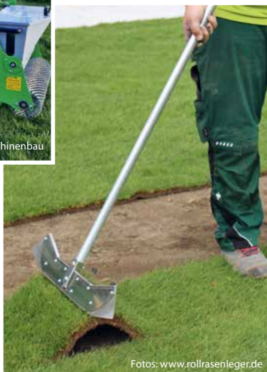
Rollrasenleger mit seitlichen Schneidflügeln zur Schonung des Muskel-Skelett-Systems
