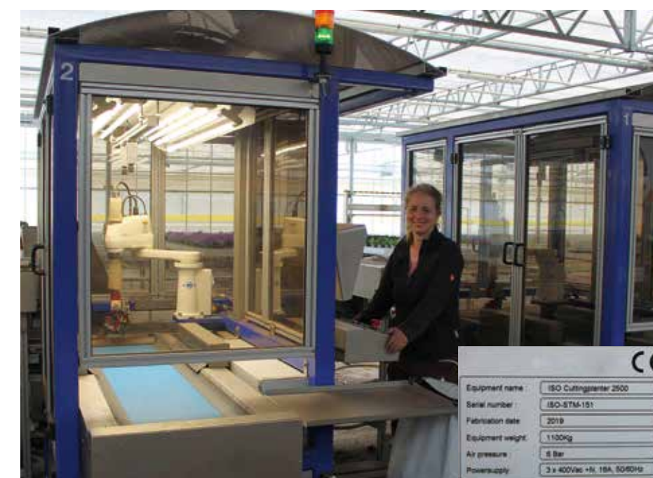
Ein gutes Beispiel für die neueste Maschinen-Generation im Zierpflanzenbau: der Steckroboter.
