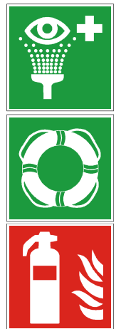
Beispiele für die Kennzeichnung für Mittel zur Ersten Hilfe (Augenspüleinrichtung, Wasser-Rettungsausrüstung, Feuerlöscher)
