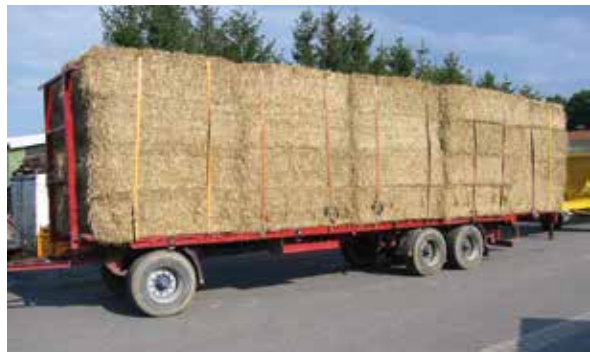
Ordnungsgemäße Sicherung von Quaderballen
