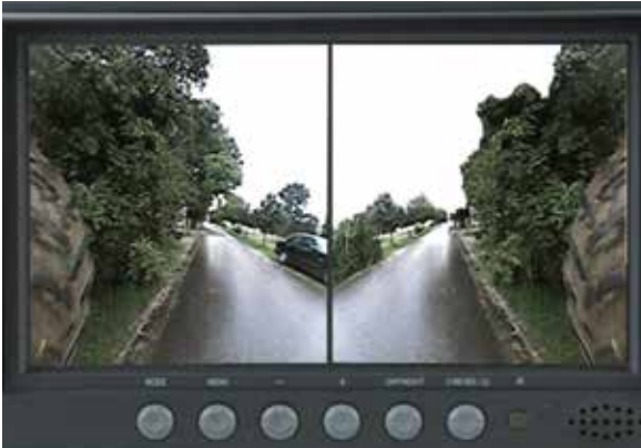
Frontkameras verbessern die Übersicht an Ausfahrten und Kreuzungen
