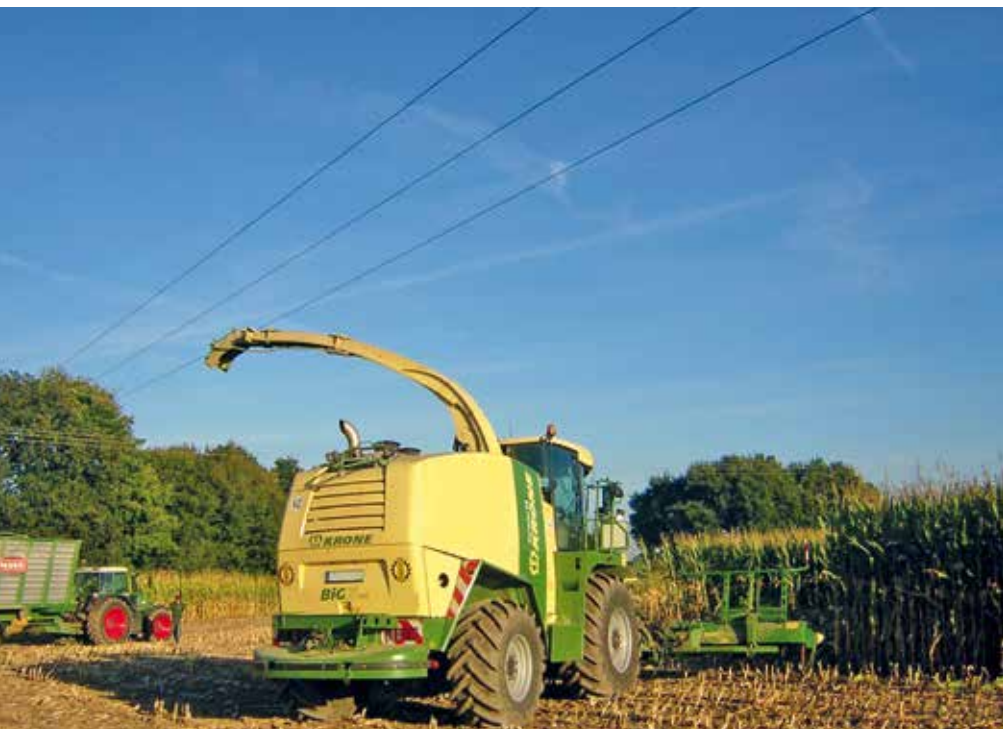
Der Auswurf von großen Feldhäckslern kann Hochspannungsleitungen berühren
