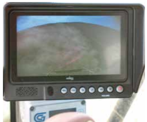
Kamera-Monitor-Systeme verbessern die Sicht nach hinten
