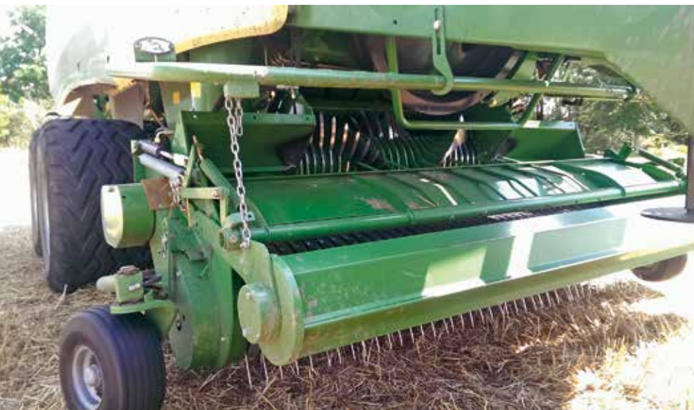
Bei Verstopfungen unbedingt Antriebe stillsetzen
