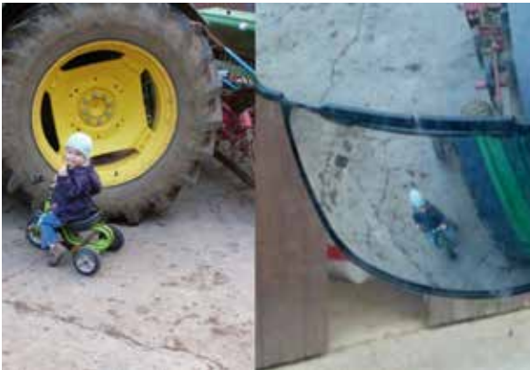
Siegelsysteme verbessern die Sicht nach hinten und zur Seite
