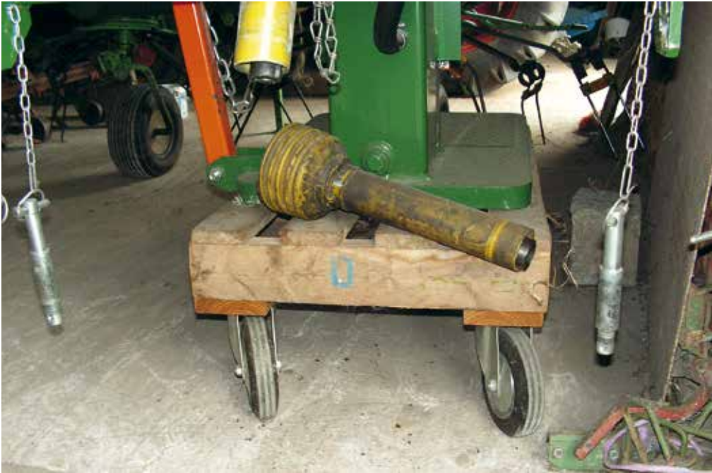
Fahrbare Unterbaugestelle können zur Kipp-Falle werden
