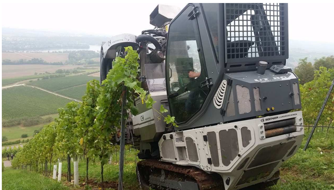
Steillagen-Vollernter mit Kettenlaufwerk sichern sich über Seilwinden gegen Umkippen. Quelle: CH engineering GmbH
