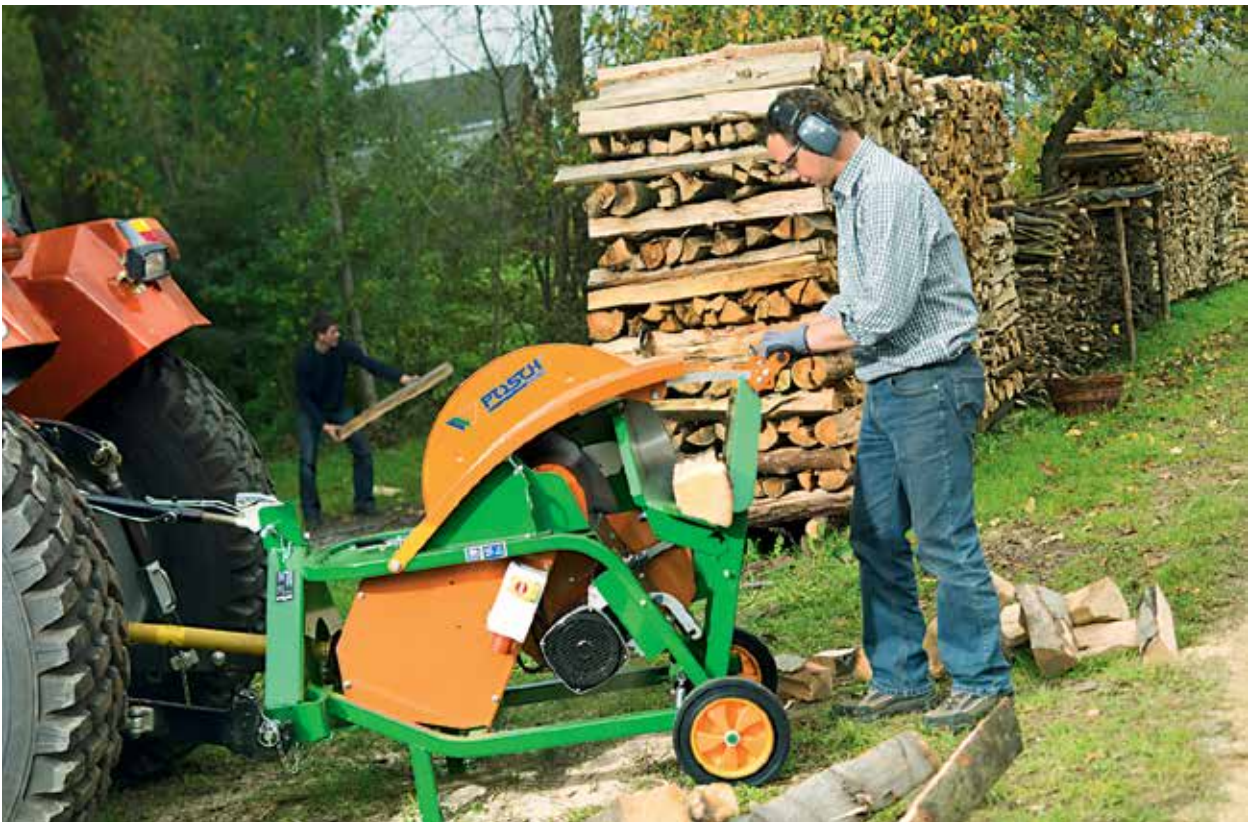
Die Abdeckung der Wippe steigert die Sicherheit beim Brennholzsägen erheblich
