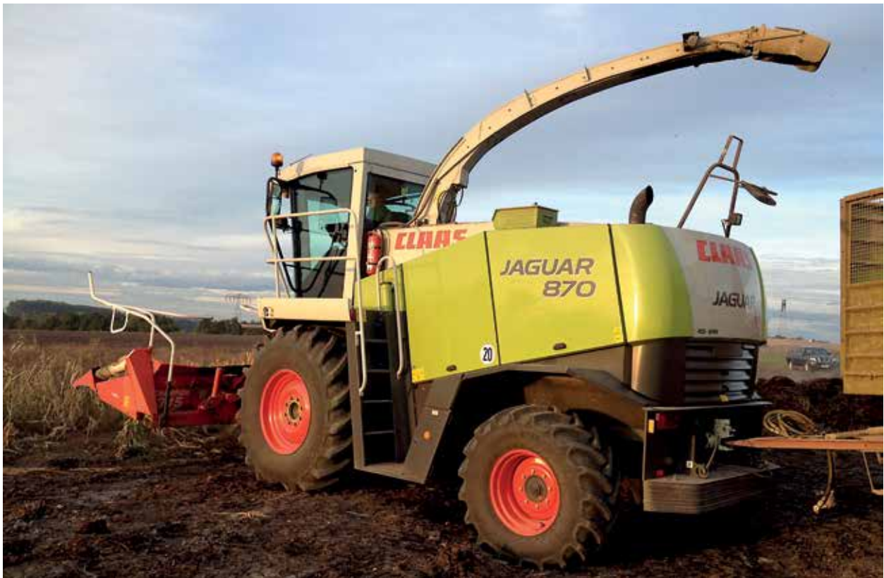
Bei Entstöruungsarbeiten muss immer der Hauptantrieb ausgeschaltet und der Stillstand der nachlaufenden Maschinenteile abgewartet werden
