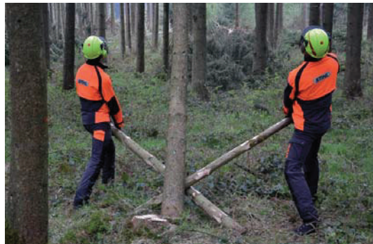
Podważanie za pomocą drągów – tylko cienkie i średnie drzewa
