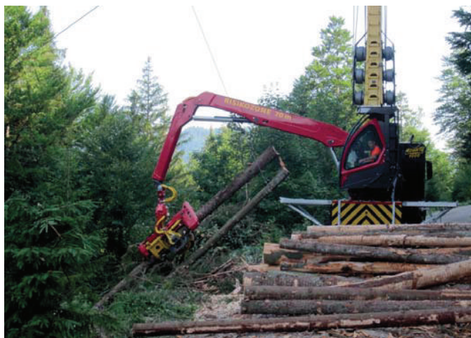
Harwester górski urządzenie linowe zamontowane na samochodzie ciężarowym. Wymagająca technika, która wymaga wysokich standardów BHP.
