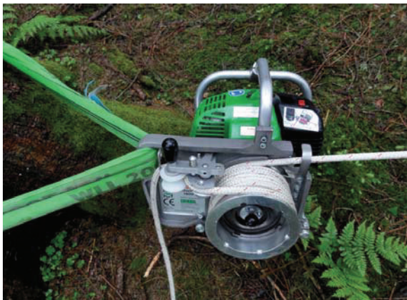
W zakresie siły uciągu do 1,8 t wciągarka bębnowa ułatwia ręczno-maszynowe prace, czyniąc je bezpieczniejszymi
