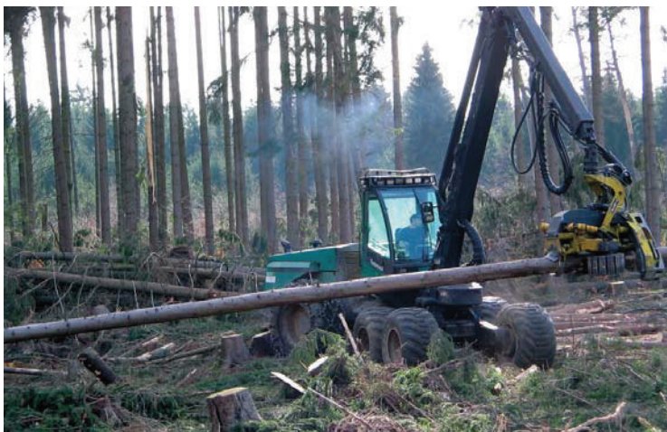
W pełni zmechanizowana wyróbka wiatrowałów
