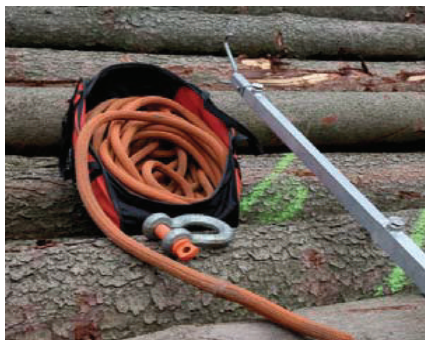
Środki pracy do wysokości instalowania lin do 6 m: drążek teleskopowy z przyporą szponową, lina do ściągania drzewa (tutaj lina z tworzywa sztucznego w płaszczu) z workiem transportowym i szekłą
