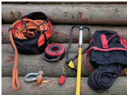
Środki pracy do wysokości instalowania lin powyżej 6 m (do ok. 15 m): rzutka, linka do rzutki z nawijaczem, linka wciągająca, miotacz rzutki (Big Shot), lina do ściągania drzewa – tutaj lina z tworzywa sztucznego w płaszczu, szekła, worki transportowe
