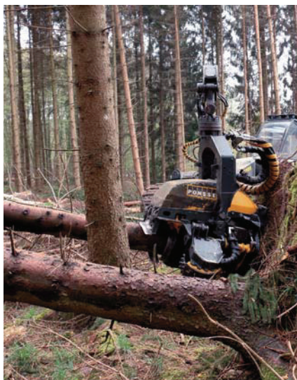
Bezpieczne eliminowanie naprężeń i obcinanie pni podczas w pełni zmechanizowanej wyróbki wiatrowałów
