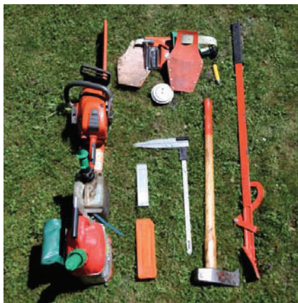
Podstawowe wyposażenie do ścinki ręczno-maszynowej
