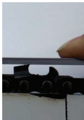
Przestrzegać średniej wysokości ogranicznika zagłębienia wynoszącej 0,65 mm!
