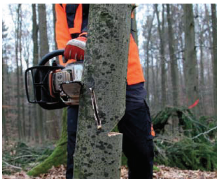
Przepiłowanie listwy bezpieczeństwa przy przekątnym cięciu sztyletowym
