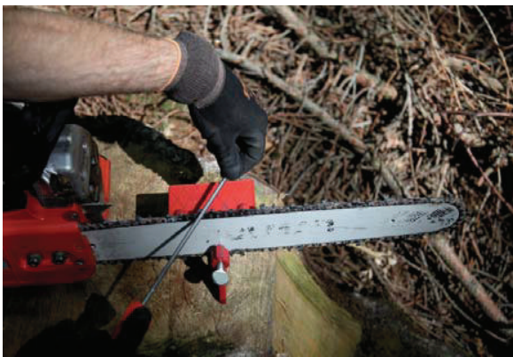
Ostrzenie w trakcie pracy. Z reguły wystarczają jedno- -dwa pociągnięcia pilnika. Imadło do ostrzenia łańcucha i przymiar do ostrzenia są nieocenioną pomocą
