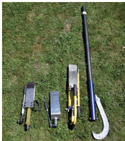
Lekki hak do obracania i „techniczne kliny do ścinki” zapewniają lepszą ergonomię podczas prac leśnych
