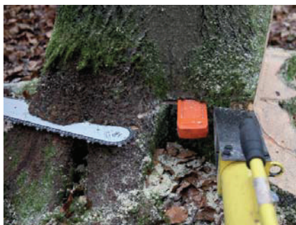
Hydrauliczny klin do ścinki
