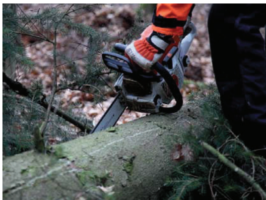
Podparcie pilarki na pniu przy technice dźwigniowej
