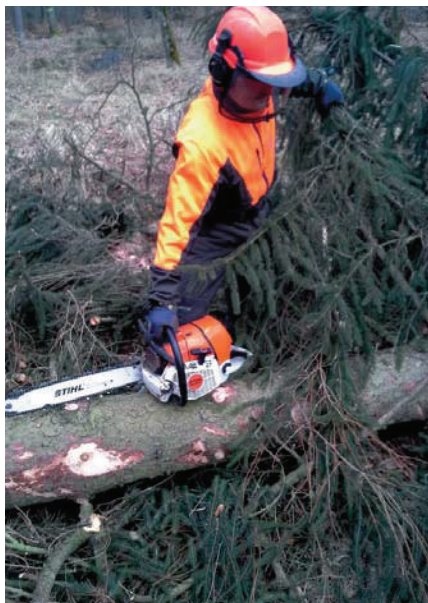
Usuwanie obciętych gałęzi z ręką sterującą gazem opartą na uchwycie jest ergonomiczne i bezpieczne
