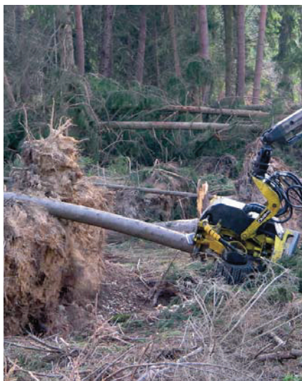
Bezpieczne eliminowanie naprężeń i obcinanie pni podczas w pełni zmechanizowanej wyróbki wiatrowałów
