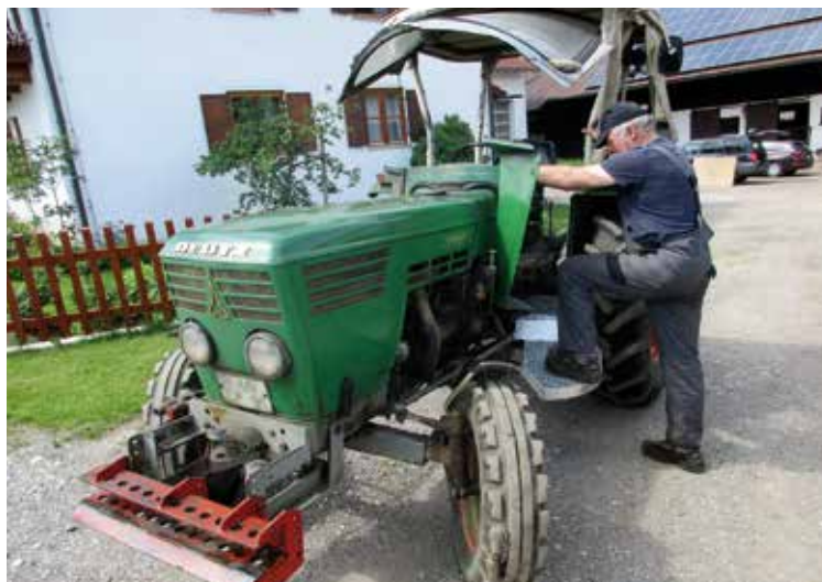
Eine große Trittstufe sowie Handgriffe sorgen für mehr Komfort und Sicherheit.
