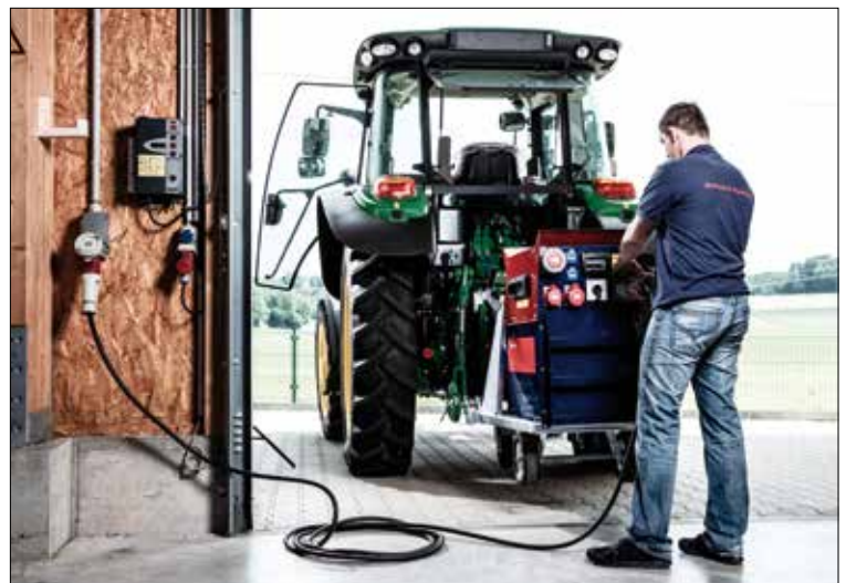
Zapfwellengenerator im Einsatz
