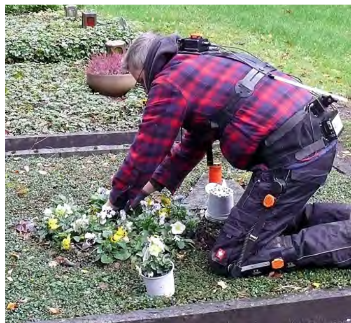
Messung der kniebelastenden Körperhaltung mit dem CUELA-Messsystem
