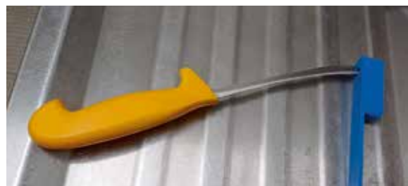
Bestandene Messerprüfung mit der Messerprüflehre: Das Messer ist in Ordnung und verwendbar.
