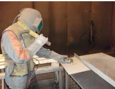
Die erforderliche persönliche Schutzausrüstung beim Einsatz einer Sandstrahlanlage
