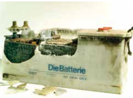
Folgen einer geladenen Fahrzeugbatterie bei unsachgemäßem Umgang.
