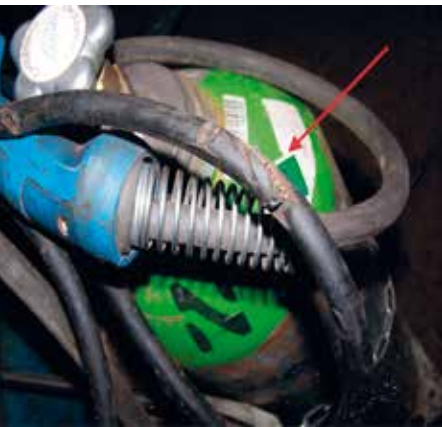
Defekte Schweißleitung, hier ist dringend ein Aus- tausch notwendig!
