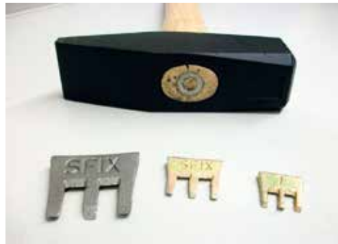
Holzstiele durch spezielle Keile, z. B. Krallenkeil, im Auge des Hammerkopfes sichern.
