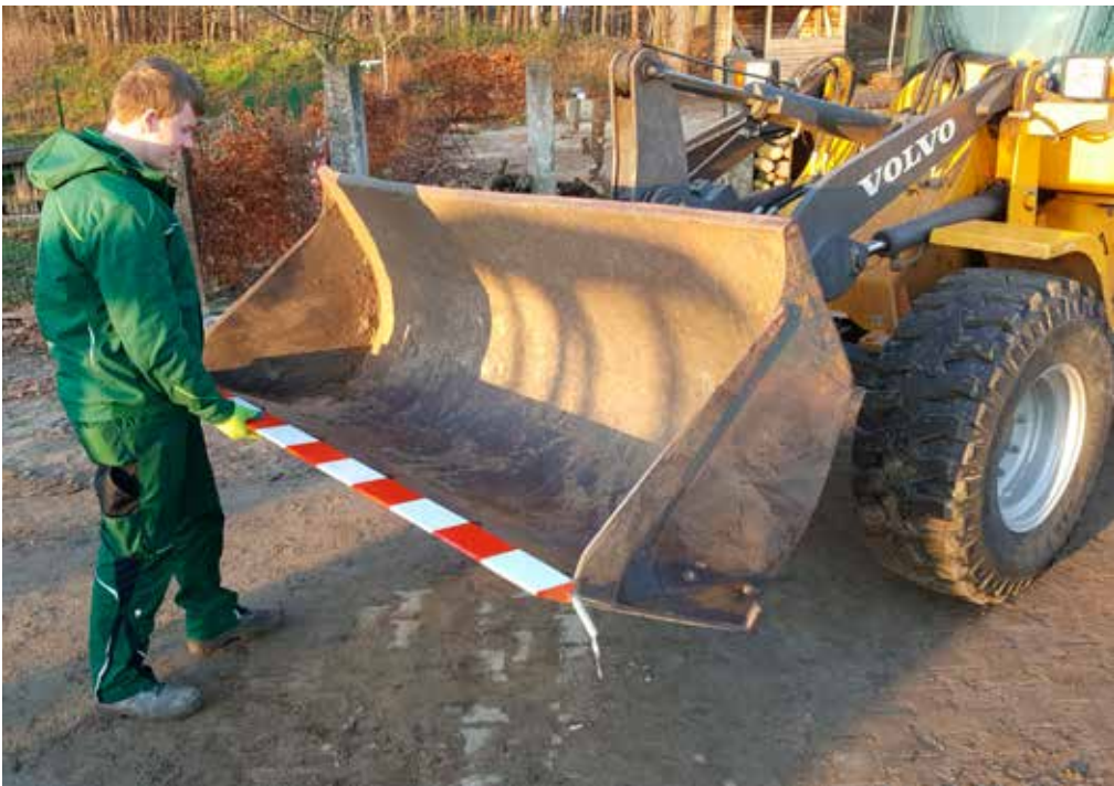
Zähne werden vor der Straßenfahrt abgedeckt
