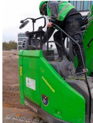
Erhöht liegender Wartungsplatz mit sicherer Aufstiegsmöglichkeit und Absturzsicherung
