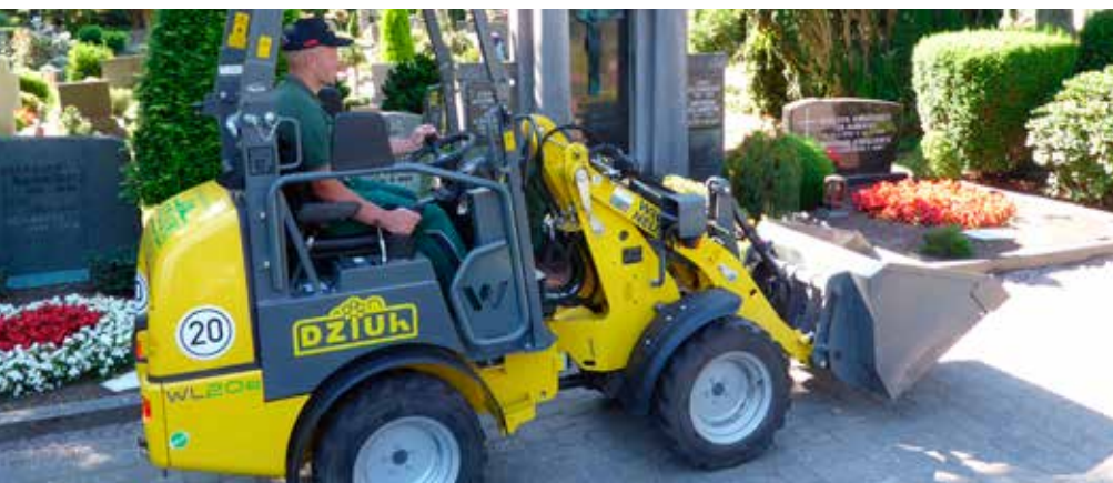
Radlader mit Elektroantrieb als geräuscharme Alternative auf dem Friedhof.
