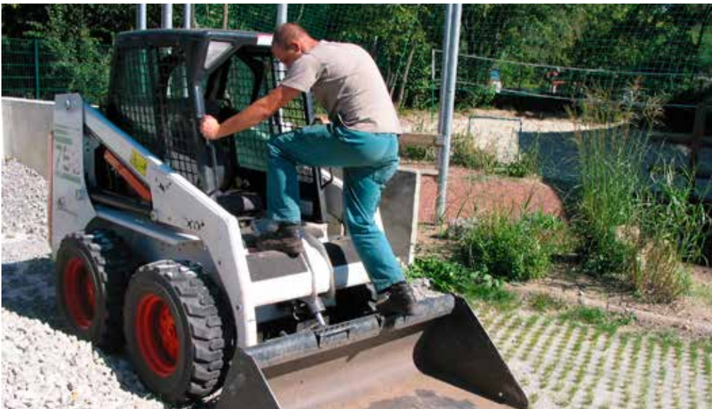
Erhöht liegender Wartungsplatz mit sicherer Aufstiegsmöglichkeit und Absturzsicherung
