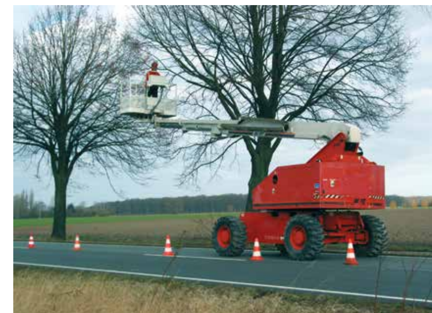
Sicher arbeiten in der Höhe mit einer Hubarbeitsbühne.
