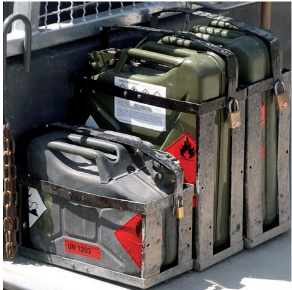
Formschlüssige Ladungssicherung mit Transportkorb
