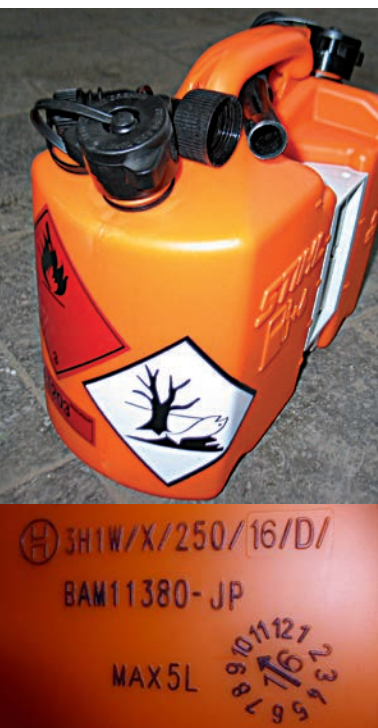
Kunststoff-Kanister UN-codiert (Bauart X), BAM-Zulassung, Herstellungszeitraum: Oktober 2016
