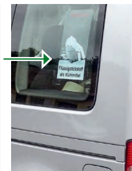
Warnkennzeichnung am Fahrzeug (an jedem Personenzugang) beim Transport von Flüssigstickstoff – UN 1977
