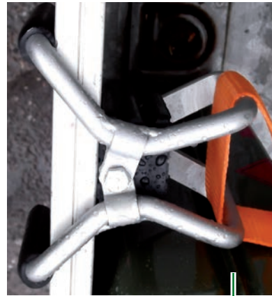
Klemmhaken zur Befestigung des Zurrgurts an der Bordwand
