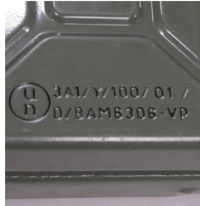
Metall-Kanister mit UN-Codierung (Bauart Y): Keine Haltbarkeitsbegrenzung, solange komplett, dicht und voll funktionstüchtig
