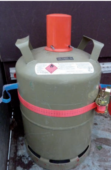
Ladungssicherung einer LPG-Flüssiggasflasche mittels Zurrurt an der Bordwand
