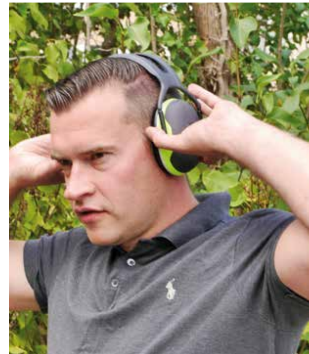
Kapselgehörschutz kann allein oder an einem Helm montiert getragen werden.
