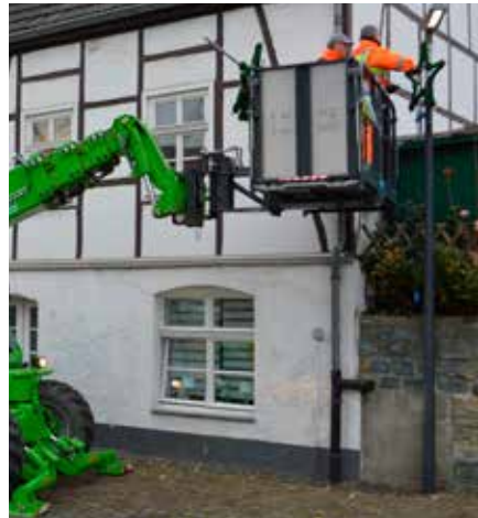
Geprüfte Kombination aus Teleskopklader mit Arbeitsplattform
