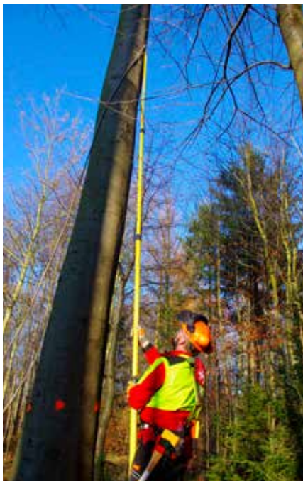
Teleskopgestänge mit Anschlagkralle zum Einbringen des Seils vom Boden aus
