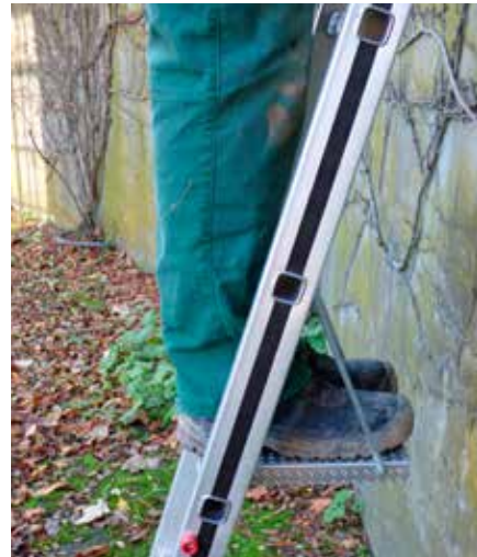
Einhängetritt für Sprossenleitern für sicheres Stehen bei kurzzeitigen Arbeiten. Auf die Belastbarkeit achten.
