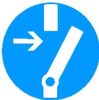
M014 Vor Arbeiten freischalten
