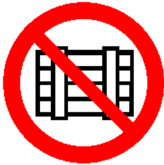
P012 Nichts abstellen oder lagern
