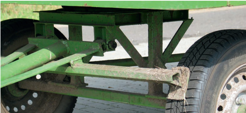
Feststellbremse in der Ausführung einer Fallbremse
