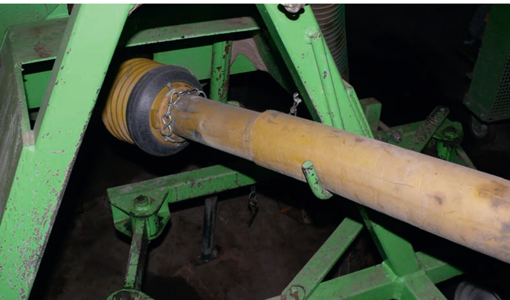
Die abgebaute Gelenkwelle ist in eine Ablage eingelegt
