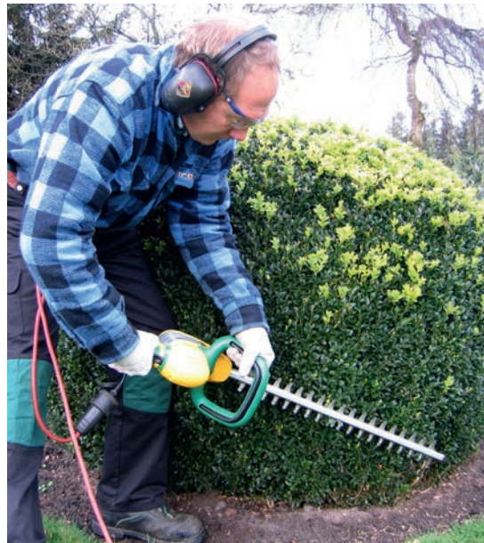
Die Elektrische Heckenschere verfügt über eine Zweihandschaltung
