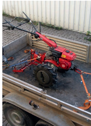
Der Einachsschlepper wird diagonal auf dem Anhänger gesichert
