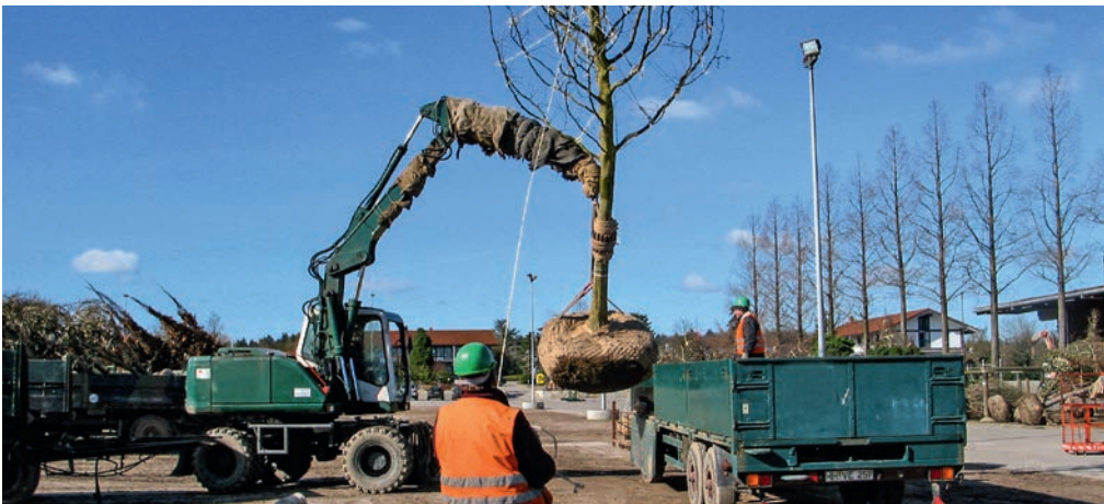
Das Führungsseil beim Verladen verhindert ein Pendeln des Großbaumes
