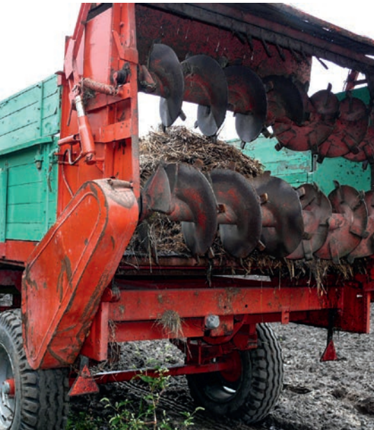
Das Antriebskettenrad des Stalldungstreuers ist mit einer Schutzeinrichtung verkleidet
