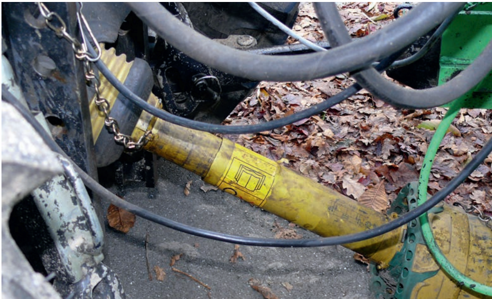
Ordnungsgemäße Gelenkwelle mit Verdrehsicherung
