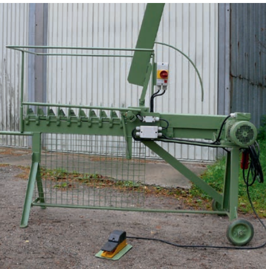
Bockschere mit Schutzbügel und Fußschalter
