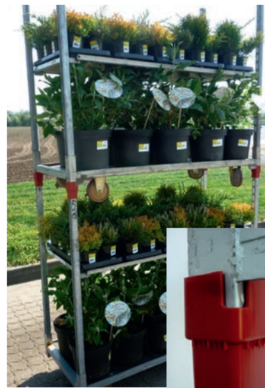
Gestapelte CC-Container, mit Steckhülsen gesichert
