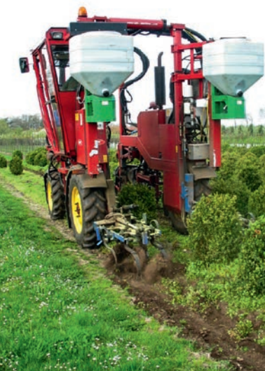
Einsatz eines Portalschleppers
