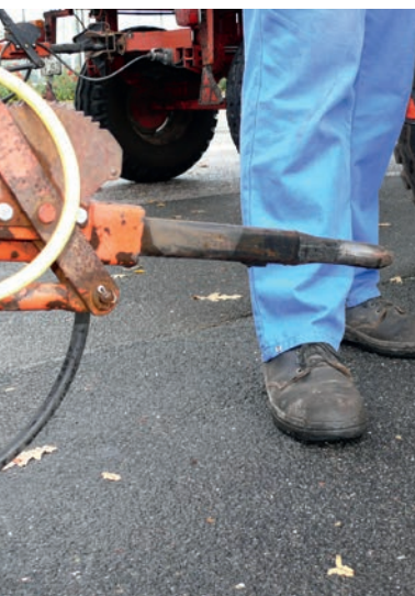
Eine bodenfreie Deichsel verhindert beim Kupplungsvorgang Verletzungen im Fußbereich
