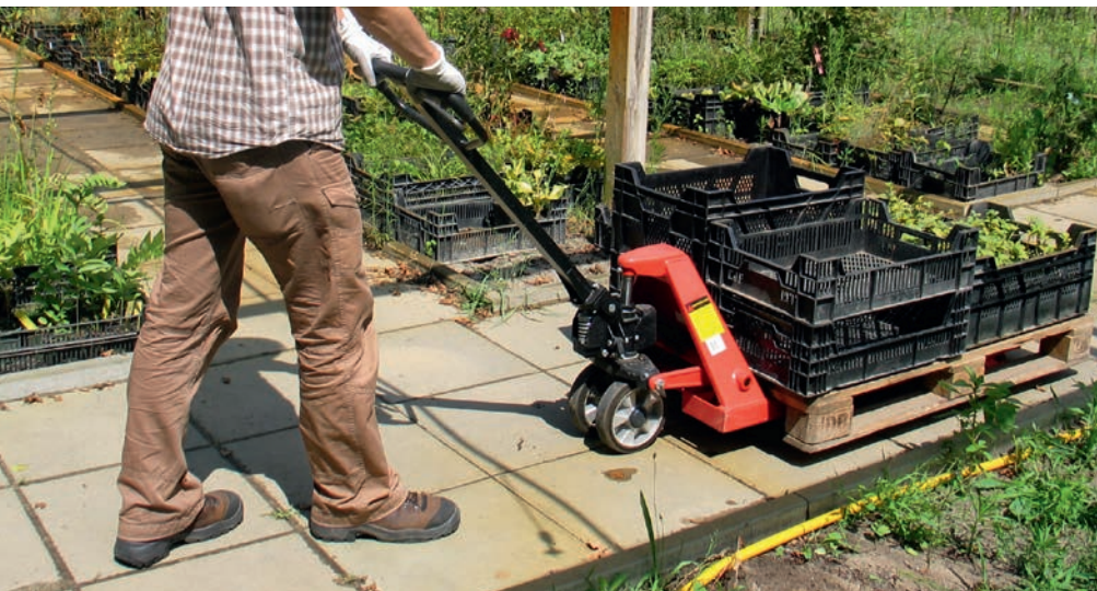
Beim Einsatz eines Gabelhubwagens wird die Last in niedrigster Position verfahren
