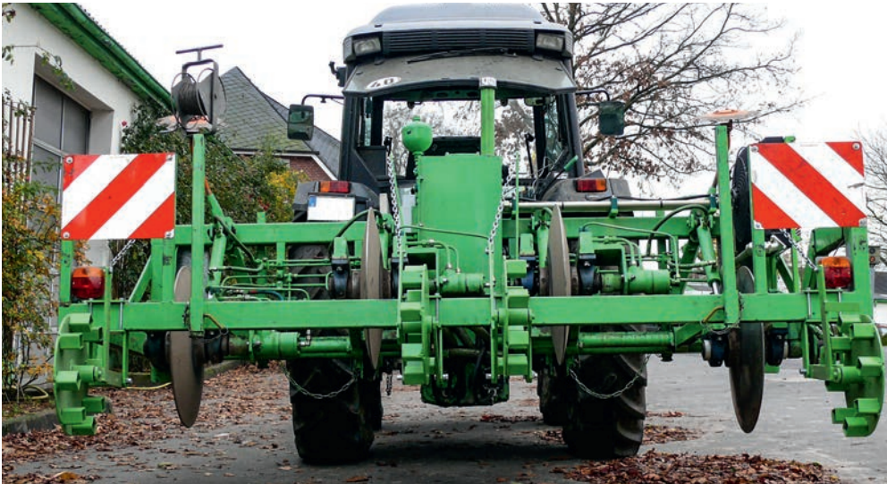
Der Schlepper mit Anbaugerät ist für den Straßenverkehr ausgerüstet und mit Rot-Weißen Warntafeln gekennzeichnet
