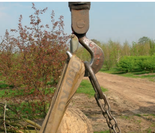
Lasthakeneinsatz: eine Klinke verhindert das unbeabsichtigte Aushängen der Last
