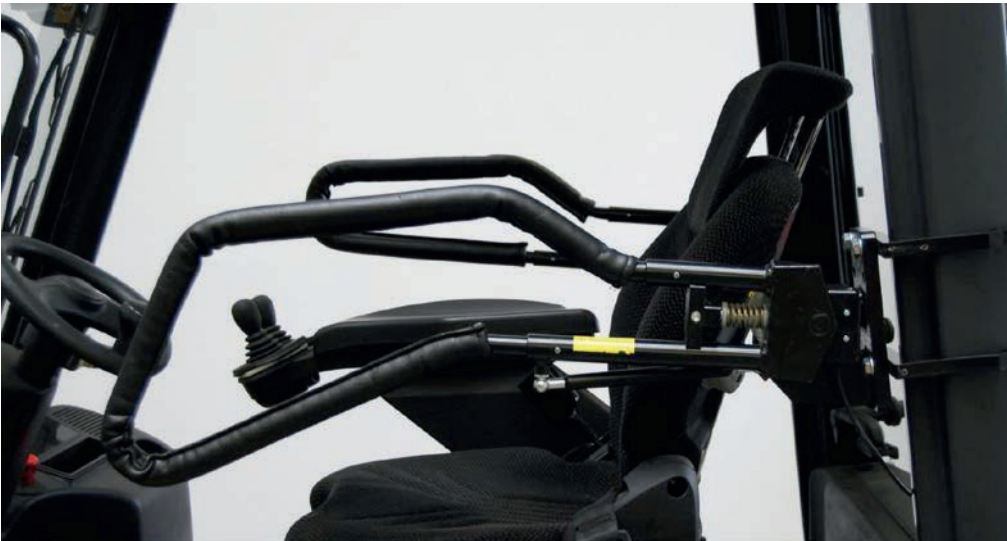
Vor dem Anfahren wird das vorhandene Rückhaltesystem eingelegt
