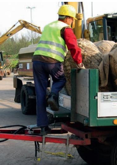
Anhänger wird über zusätzlich angebrachten Tritt bestiegen
