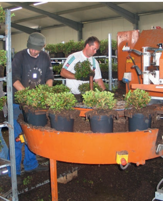
An jedem Arbeitsplatz an der Topfmaschine befindet sich ein Schalter mit Nothaltefunktion
