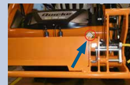
Verriegelungshebel offen Position links (aus Fahrersicht)
